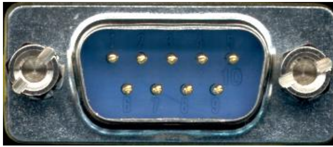
Hình 4.2 – Sơ đồ chân cổng nối tiếp
